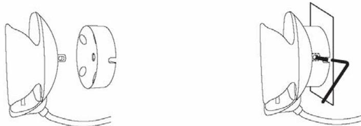
Stecken Sie die Halterung in den Sockel (nicht mit Gewalt!) und bringen Sie diese in die gewünschte Position. Ziehen Sie nun die Stellschraube am Sockel mit dem dafür vorgesehenen Imbusschlüssel fest. Nicht mit Gewalt durch die Achse drehen, sondern nur Anziehen um die Bewegung der Halterung zu unterbinden. Einmal befestigt, versuchen Sie nicht mit Gewalt die Halterung zu bewegen! Lösen Sie zuerst die Stellschraube.
